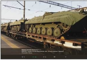
BMD 1 amf APC in gebruik bij Luchtlandings ehdn. Kan per parachute worden gedropt. Gew. 7.5 t motor 15.9 l diesel 241 PK. Kent vele varianten. Deze heeft geen gev toren met kn. Mogelijk is dit de BMD 1 KSH comms vtg.
