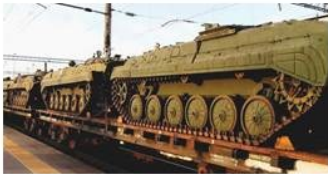
BMP 1: amfibische APC Inf. Gev vtg. Gew 13.2 t bew 73mm 2A28 GROM kn. en lanceerinrichting voor ATGM motor UTD-20 15.8 L diesel 300pk
